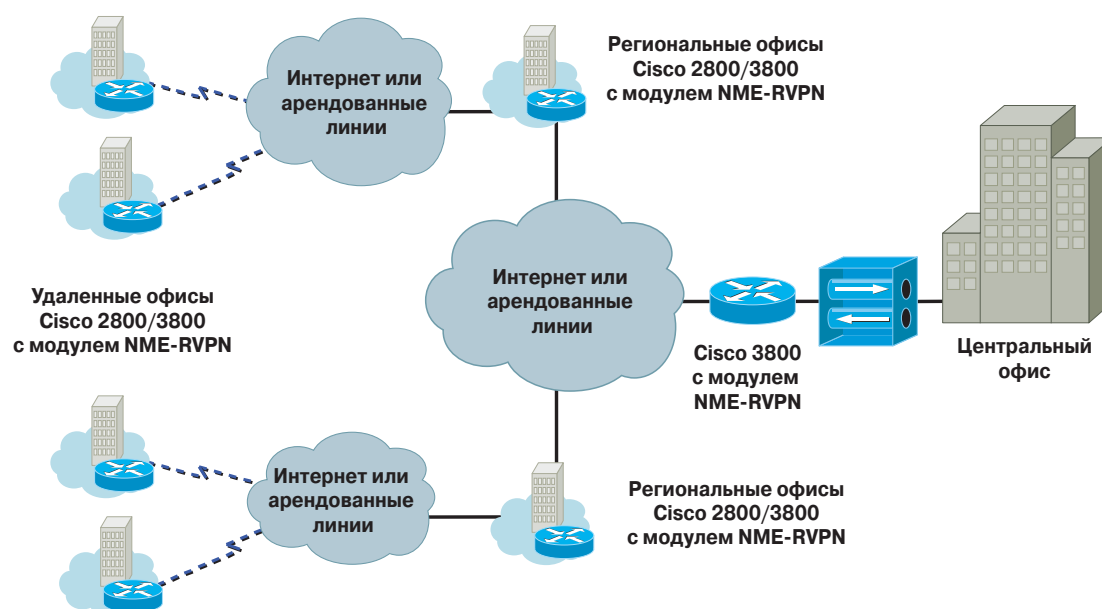
Рисунок 2. Использование VPN-туннелей для создания защищенной корпоративной сети
