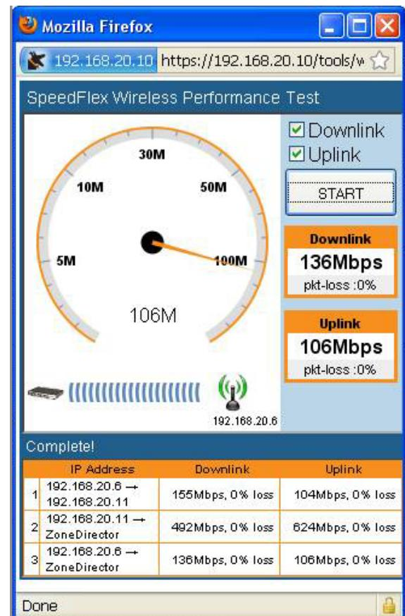
SpeedFlex™ является уникальным инструментом тестирования производительности беспроводной сети, встроенным в семейство централизованных контроллеров ZoneFlex™, с помощью которого можно измерять пропускную способность между сетью Wi-Fi и клиентами беспроводной сети.
