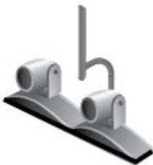
При включенном слежении камеры EagleEye Director, камера слежения следит за говорящим человеком или людьми. Такой процесс слежения, также называемый автоматическим позиционированием камеры, можно включать и выключать вручную.
