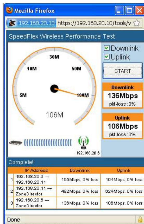
SpeedFlex™ является уникальным инструментом тестирования производительности беспроводной сети, встроенным в семейство централизованных контроллеров ZoneFlex™, с помощью которого можно измерять пропускную способность между сетью Wi-Fi и клиентами беспроводной сети.
